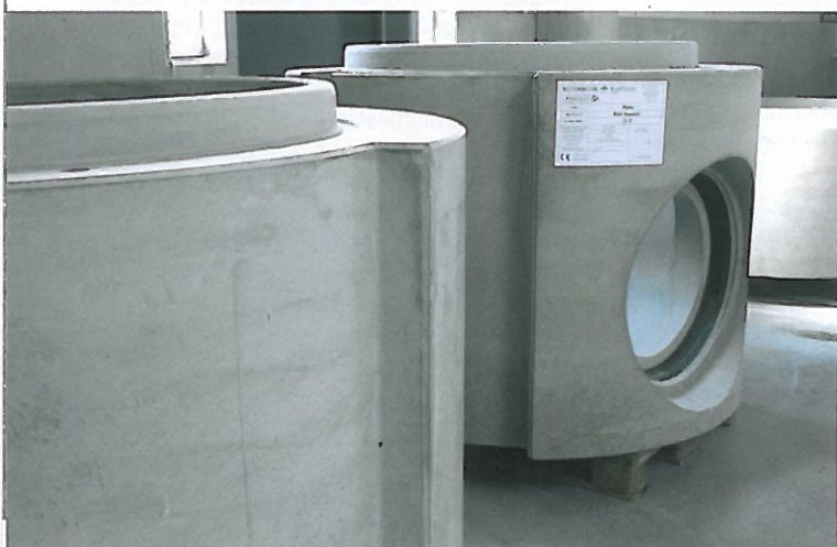
Monolithische Schachtunterteile werden im Betonwerk Müller mit Anschlüssen bis DN 1000 gefertigt. Zur Gewichtsoptimierung wird die Wandstärke partiell reduziert.
