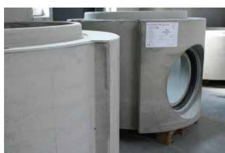
Monolithische Schachtunterteile werden im Betonwerk Müller mit Anschlüssen bis DN 1000 gefertigt, die Schachtunterteile für das Baulos Neublach zB mit Nennweite DN1200 für Robust-Rohr-Anschluss DN500.
