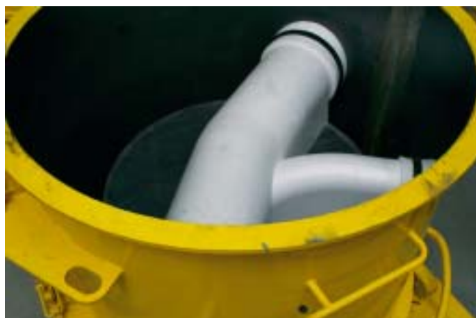
Vorbereitung einer Stahlform für die Fertigung eines individuellen monolithischen Betonschachtunterteils – im Bild die Gerinne-Aussparung.
